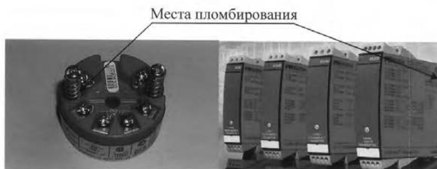
Рис.3 Внешний вид преобразователей измерительных PR серии 6.
